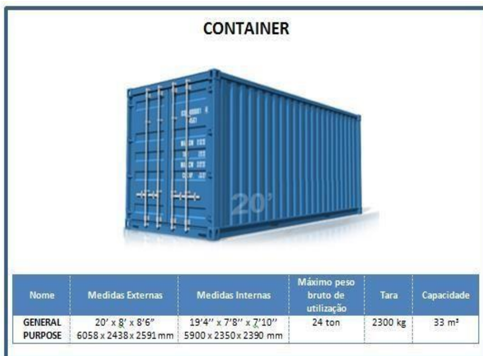
FIGURA 02 - Medidas de um container de 20'
